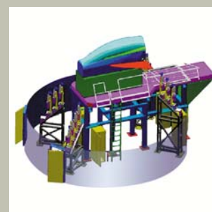
Installation en escalier des 14 projecteurs de cibles autour de la cabine du F-18
